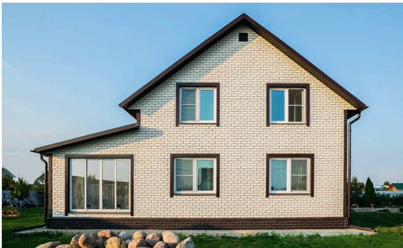
Панели на фасаде Колотый камень, коллекция Дизайн, цвет Молочный со швом RAL 7006 Панели на цоколе Колотый камень, коллекция Дизайн, цвет Шоколадный со швом RAL 7006
